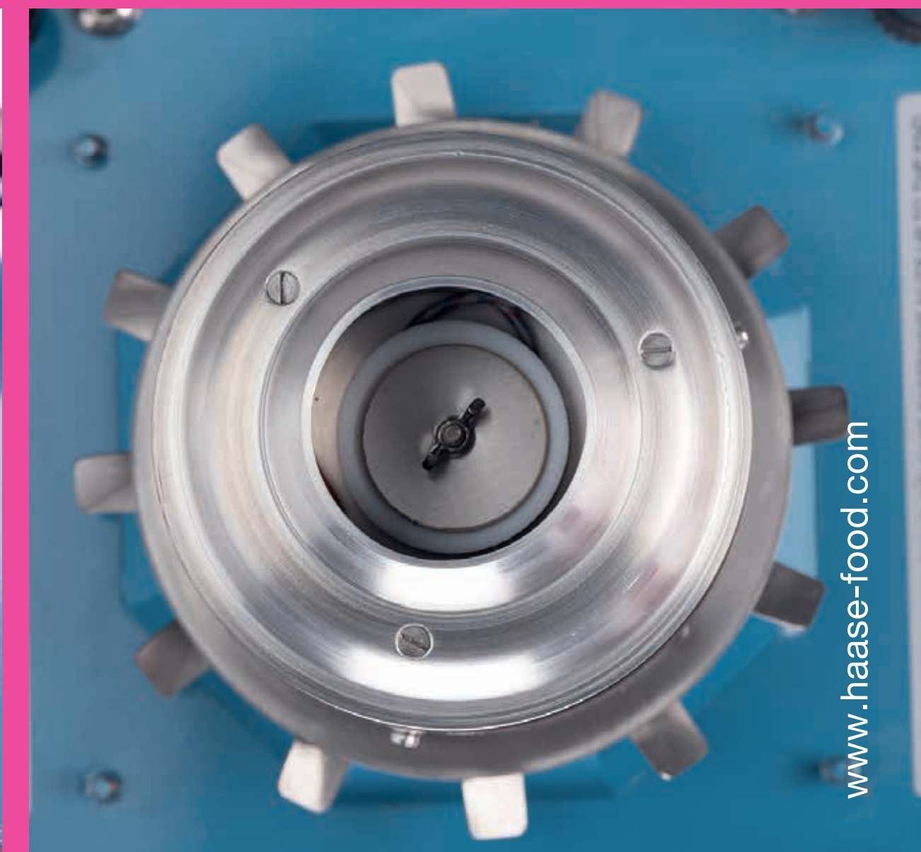
Blick von oben: Der Ventilator unterhalb vom Spinnkopf.
