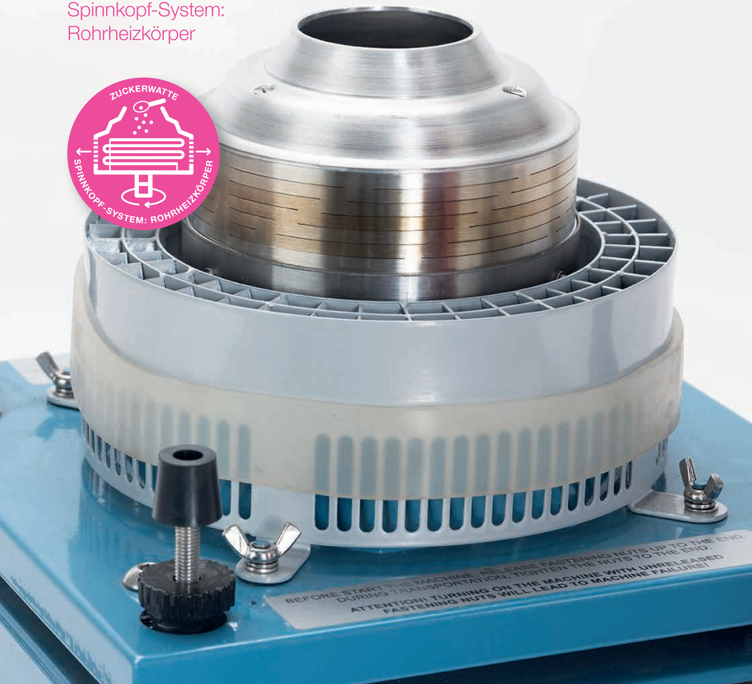
Der Spinnkopf mit patentierter Luftstrom-Technik. Der verschiebbare Silikonring steuert den Luftstrom/Auftrieb und beeinflusst den Flug der Zuckerwatte.
