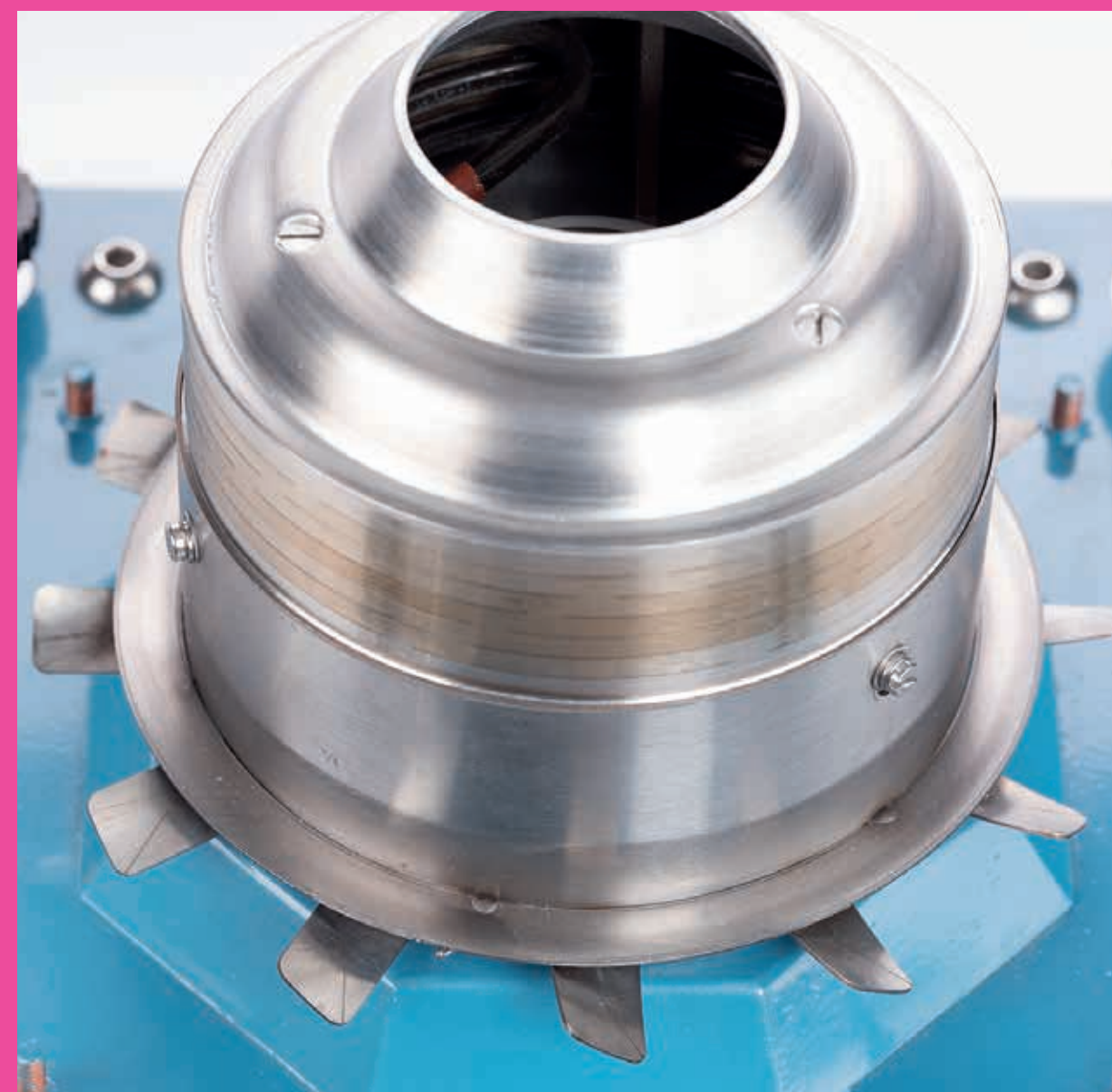
Der Spinnkopf ohne Düsenaufsatz gibt den Blick frei auf den Ventilator.
