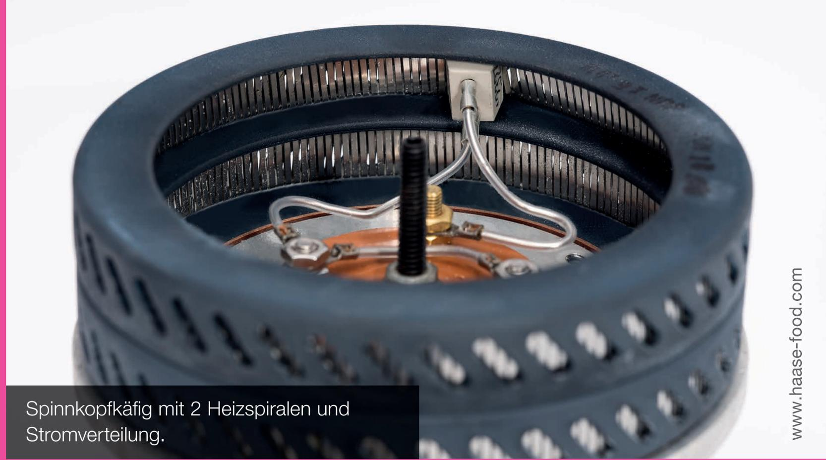
Spinnkopfkäfig mit 2 Heizspiralen und Stromverteilung.
