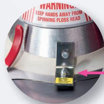
Federsystem/Stoßdämpfer und Transportbefestigung
